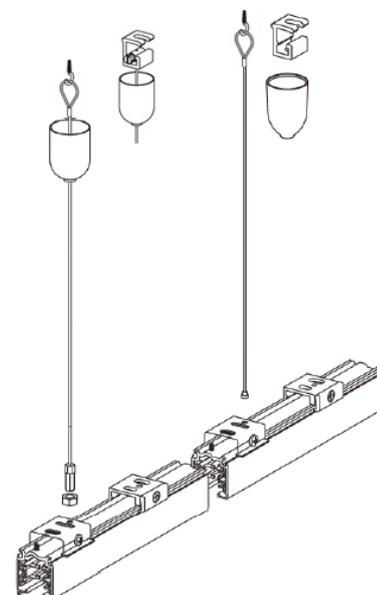
Рис. 7. Крепление шинопровода с помощью подвесов
