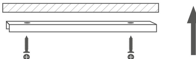
Рис. 6. Крепление шинопровода с помощью крепежных элементов
