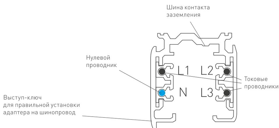
Рис. 3. Конструкция шинопровода
