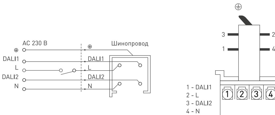
Рис. 5. Схема подключения
